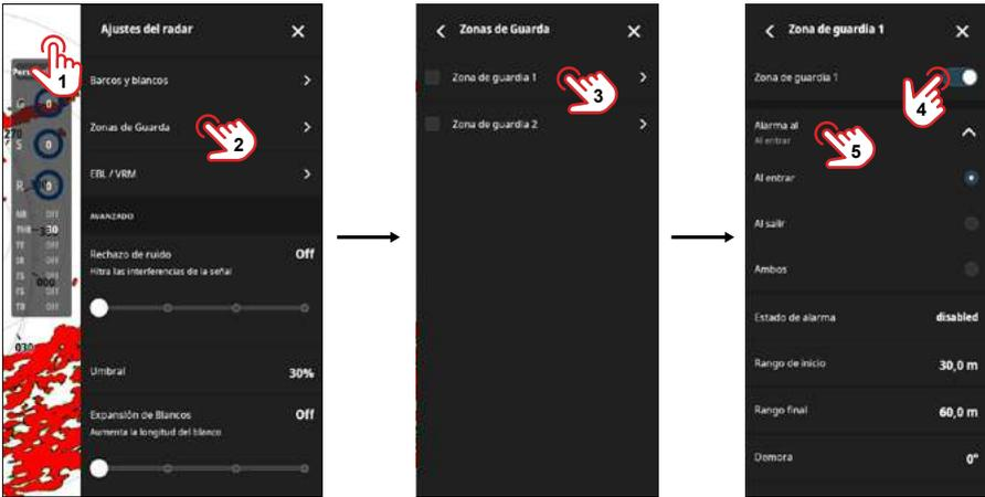
Ajuste la zona con los botones (6) o seleccione los parámetros de la zona de guarda **Rango de inicio**, **Rango final**, **Demora** o **Anchura** y utilice la barra de desplazamiento para establecer los diferentes valores.
