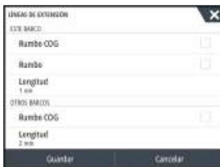
La información de rumbo de la embarcación se obtiene del sensor de rumbo activo, y la información COG, del sensor GPS activo.
