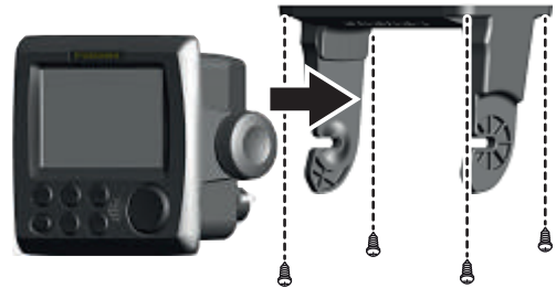
Montaje en techo
